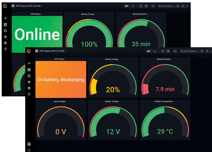
Bild 2: Grafana visualisiert den Betriebszustand der USV übersichtlich in einem Dashboard.
